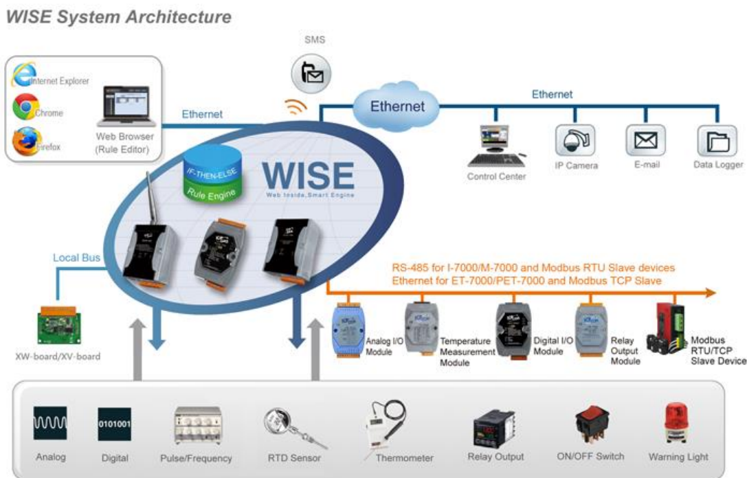
图 1-1: WISE 系统架构
